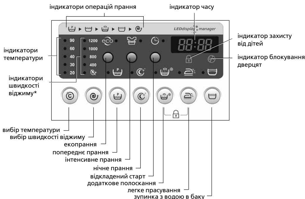
Рисунок 3 – Зони індикації і кнопки вибору додаткових функцій
