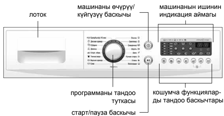
1-сүрөт — Башкаруу панели
